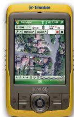
Abbildung 3: Datenerfassungsmaske für die Geländeaufnahme mit Juno SB von Trimble
